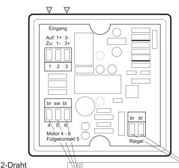
Motorzuleitung von der Steuerzentrale: 24VDC g e s i e b t
